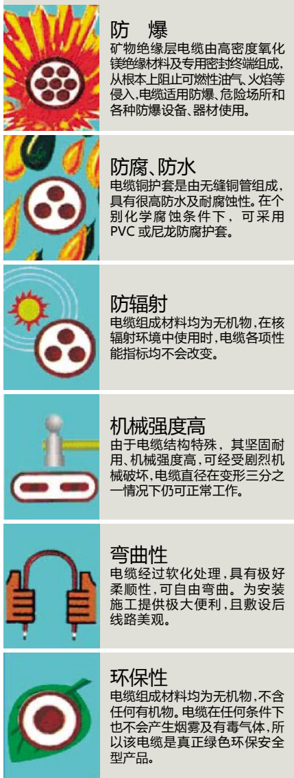
图5 耐温 600°C安泽铠装矿物绝缘 加热电缆特性展示
