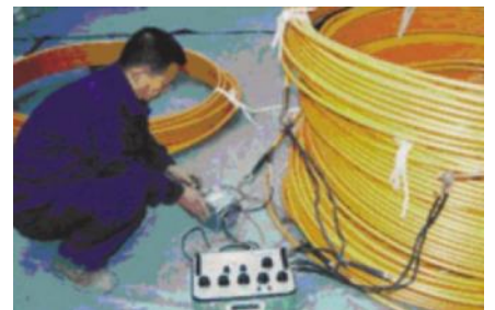
图 7 电缆导体直流电阻与绝缘电阻检查
