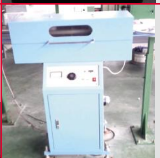
该仪器为高压火花机，车间里一共有8台高压火花机，从第一道工序到最后成品工序，每个工序都有高压火花机，产品从内到外都能经受6kV的高压测试。保证了产品的安全性。
