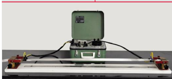
该仪器为直流双臂电桥，该仪器精确度很高，能精确读到小数点后面四位小数，每批原材料进厂时品质部都会进行很精准的阻值测量，严格控制好源头。
