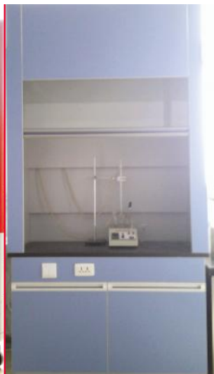
该装置为交联度测试装置，通过二甲苯萃取的方法准确测量交联线芯的交联度，我们会对每批交联原材料进行交联萃取试验，准确测量线芯交联度。该试验涉及到二甲苯(有毒)需要经过培训的专业人员进行操作。
