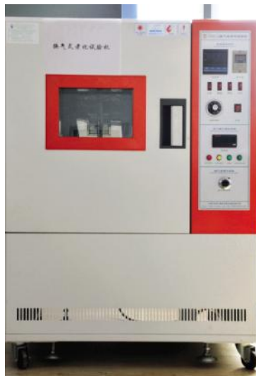
该仪器为换气式老化箱，每天早上品质部会有专门的试验人员按照国家标准对生产的线芯做交联热延伸试验和永久变形试验，并对生产的成品线做护套老化试验。
