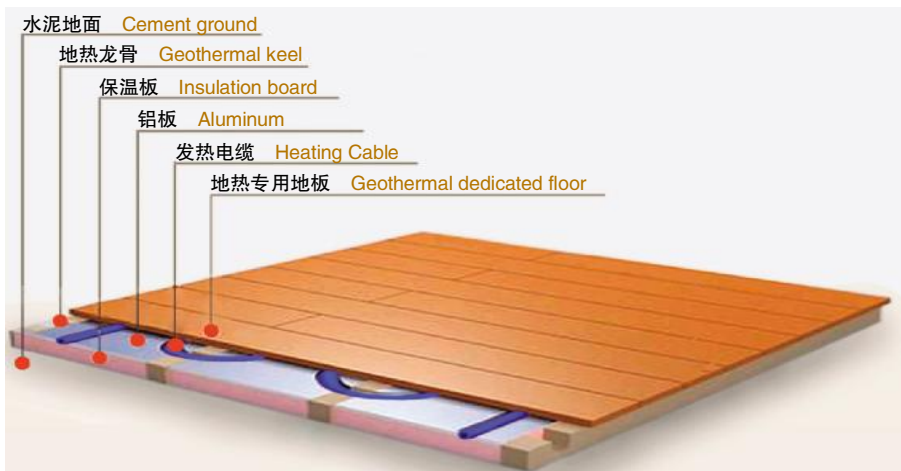
图2 干式发热电缆采暖铺装
