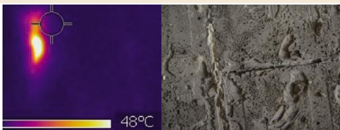
四川一客户组合床下(该床与地面密封,床下有木板和抽屉,内放棉被和衣物)用故障检测仪检测出断路点,刨开地面发现电缆被烧断,附近的电缆外护套已明显变色,为局部覆盖产生高温散热不均匀造成。
