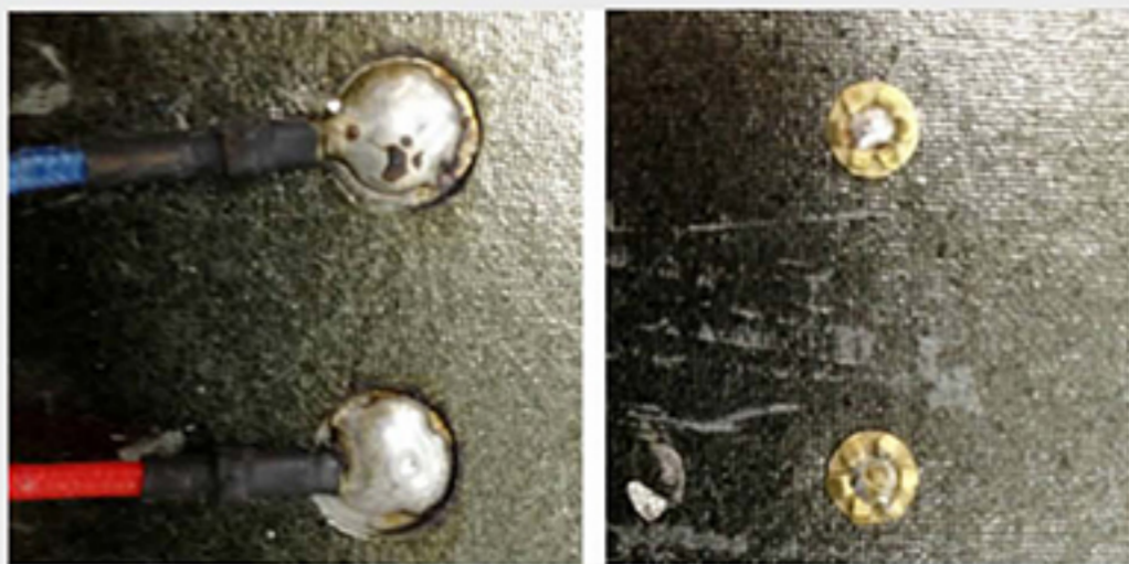
安泽金属膜发热板接头工艺(接头完好)
