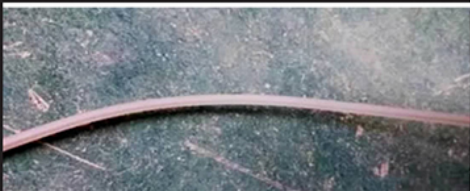
FEP+XLPE 绝缘 高温时,XLPE 表面略发软,外观无缺陷 注:优质的 FEP(特氟隆)为无色透明的
