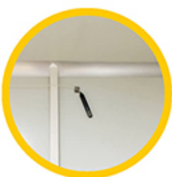
室内不同位置温湿度探头检测不同方位的温湿度
