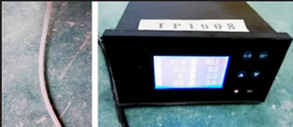
FEP+XLPE 双绝缘电缆 20W/M 时,正常,25W/M 时,93.1 度,表面略发软
