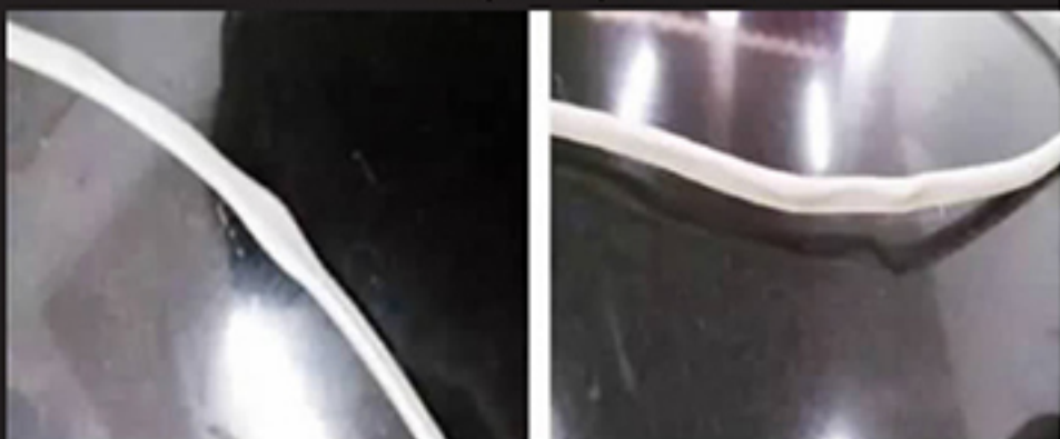
硅橡胶绝缘 高温时,绝缘层与发热丝完全脱离,发热丝在没有绝缘层保护时,在内应力作用下弯曲变形
