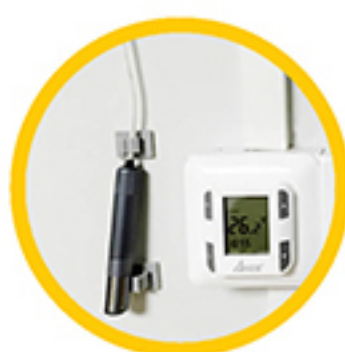
室内不同位置温湿度探头检测不同方位的温湿度
